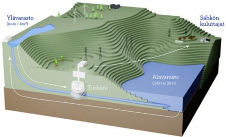
Kuva 3-1-1. Yleispiirteinen kuva pumppuvoimalaitoksen toimintaperiaatteesta.
