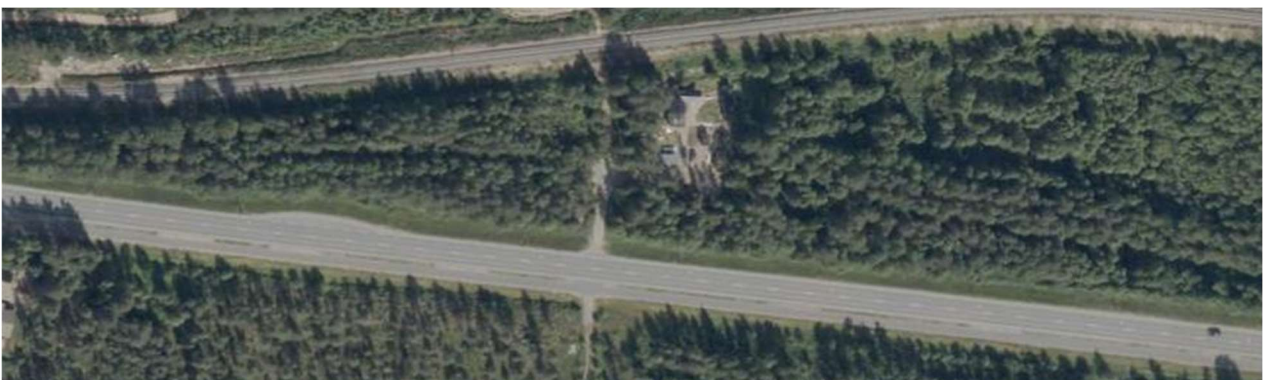
Kuva 4. Ilmakuva Kemijärven karttapalvelusta. Sähkölínjan maakaapeloinnin työura näkyvissä kiinteistön oikealla puolella, menee piha-alueelta kohti tien reunaa.
